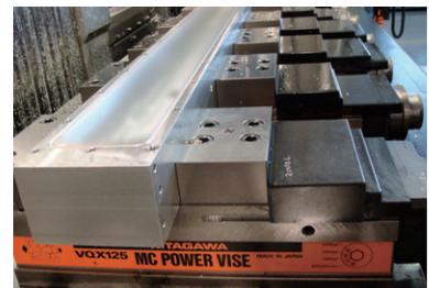
▲長尺物の精密機器部品を加工
