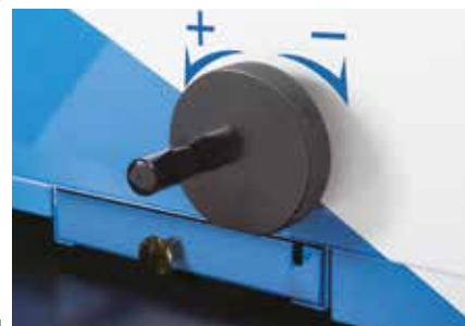
Ajuste de longitud de proyección de la herramienta de corte (opcional). Cutting Tool Projection Length Adjustment (Optional)
