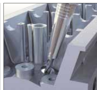
Barrenado en espacio angosto Drilling in tight space
