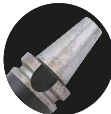
Superficie oxidada de un producto estándar Rusted surface of standard product
