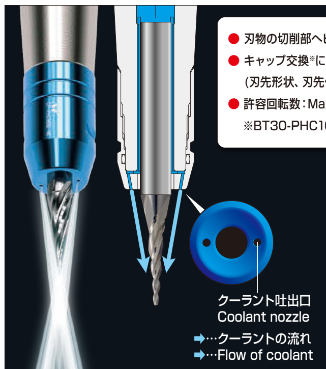
テーパエンドミル加工 (インペラー加工など) Taper Endmill Machining ( for Impeller etc)
